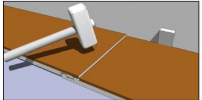
Die folgenden Dielen der ersten Reihe werden stirnseitig passend eingelegt und durch leichtes Klopfen mit dem Gummihammer von oben fugenfrei verbunden. Das Endstück wird passgenau gekürzt und eingesetzt. Achten Sie dabei immer darauf einen Wandabstand von ca. 1 cm mittels Abstandskeilen freizuhalten.
