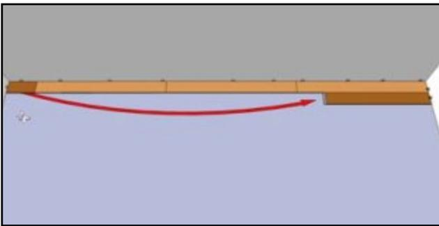
Der verbleibende Abschnitt der vorhergehenden Dielenreihe wird in der Regel zum Anfang der nächsten Reihe verwendet. Das Anfangsstück wird rechts an die bereits verlegte Reihe passgenau angelegt. Die lange Seite wird dann einige cm (ca. 15°-Winkel) angehoben bis das Profil ineinandergreift und dann heruntergedrückt, bis es fugenfrei einrastet.
