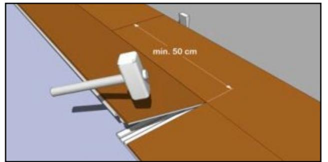
Der Kopffugenversatz sollte mindestens 50 cm betragen. Die weiteren Elemente werden ebenso montiert. Die stirnseitige Verbindung wird beim Herunterklappen von oben mit einem leichten Schlag des Gummihammers eingerastet.
